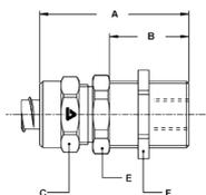
Adattore per sensore per Anaconda Sealtite, IP 65
